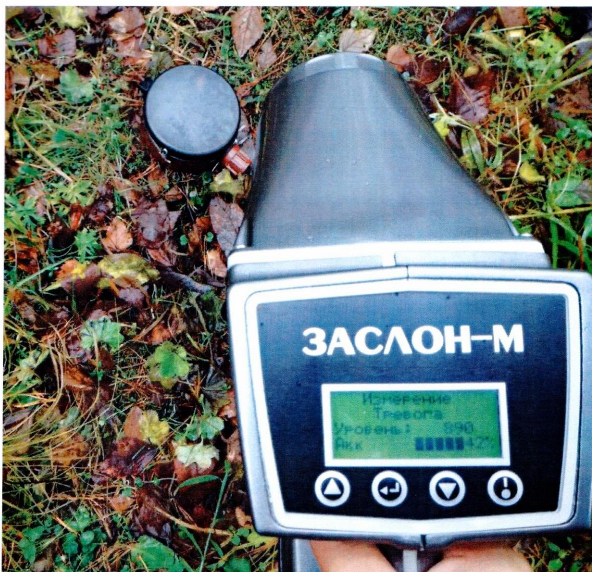
Рисунок 8 – Фиксация паров ВВ, исходящих от противопехотной мины ПМН
