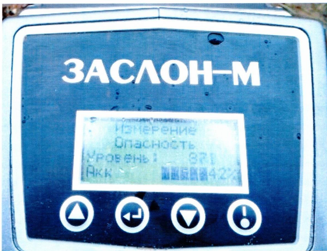
Рисунок 18 – Процесс регистрации паров ВВ от СВУ в условиях отличного от нуля фона паров ВВ в окружающем воздухе
