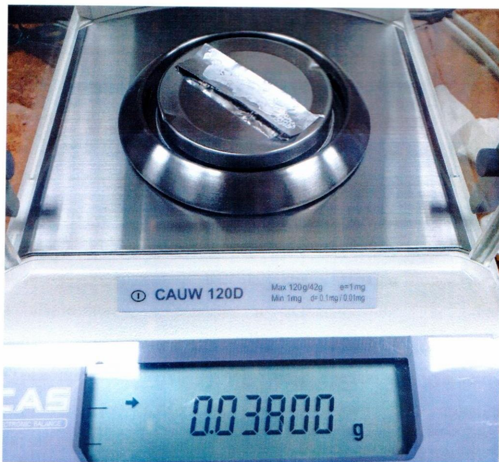
Рисунок 5 – Взвешивание пробы ТНТ перед началом эксперимента
