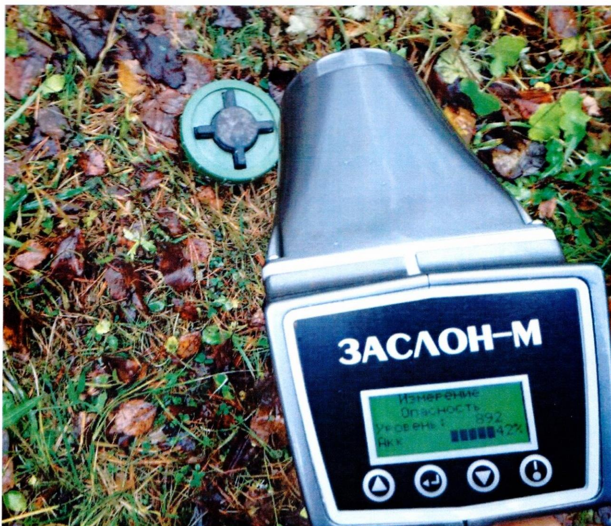
Рисунок 10 – Фиксация паров ВВ, исходящих от противопехотной мины ПМН-2
