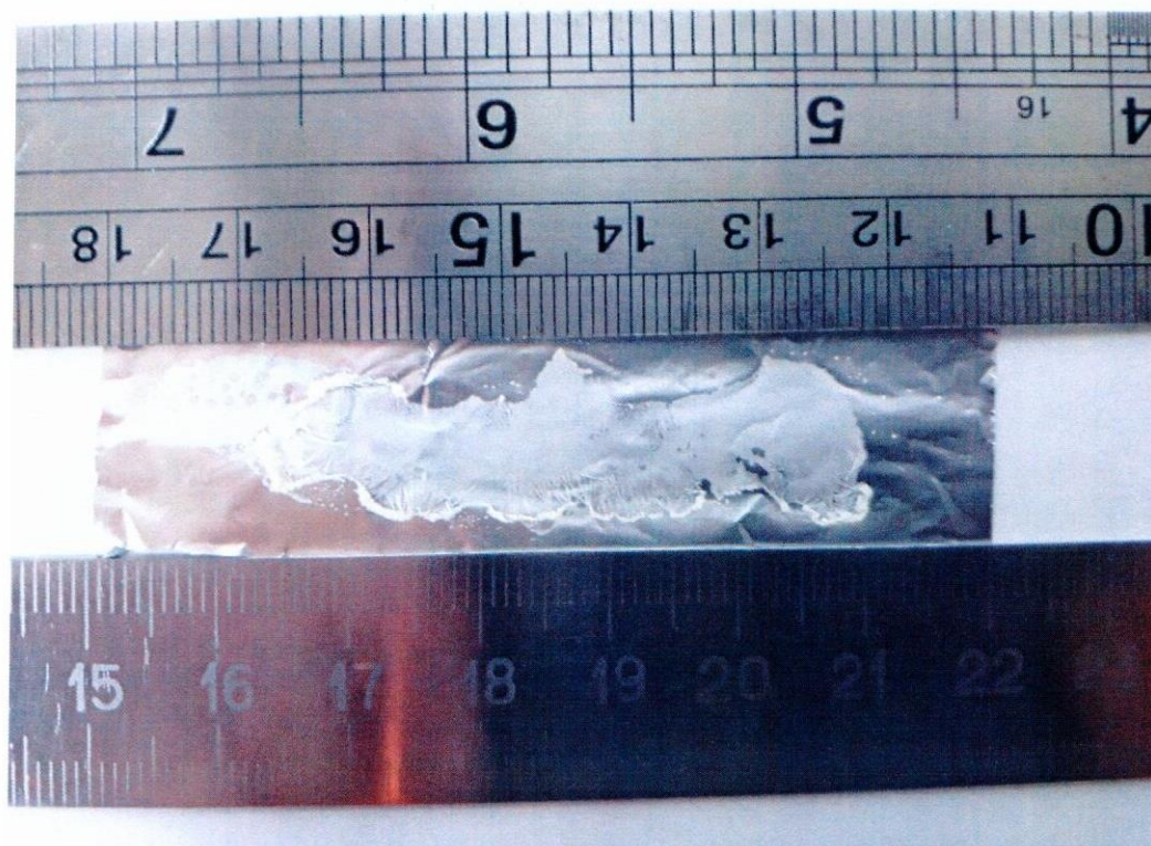
Рисунок 4 – Полученная проба ТНТ для проведения эксперимента по определению чувствительности прибора «Заслон-М»
