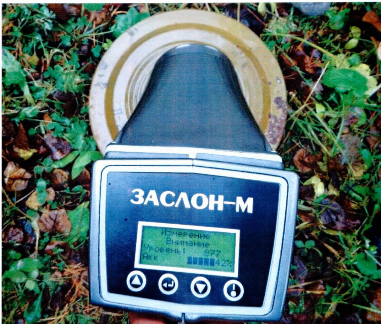
Рисунок 12 – Фиксация паров ВВ, исходящих от противотанковой мины ТМ-62М
