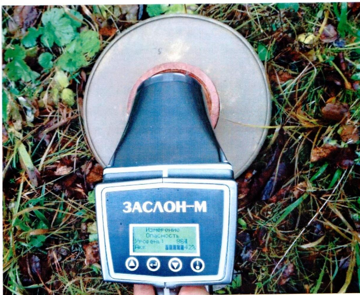
Рисунок 14 – Фиксация паров ВВ, исходящих от противотанковой мины ТМ-62ПЗ
