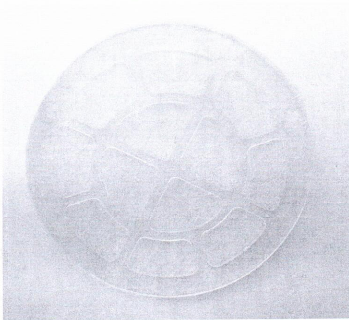
Рисунок 10 – Чувствительный элемент прибора «Заслон-М» пропитанный органическим люминофором
