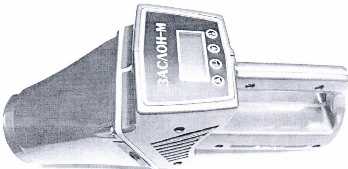
Рисунок 1 – Мобильный обнаружитель нитросодержащих взрывчатых веществ «Заслон-М»
