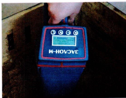
Рисунок 23 – Обнаружение противопехотных мин, установленных в грунт, прибором «Заслон-М»:
