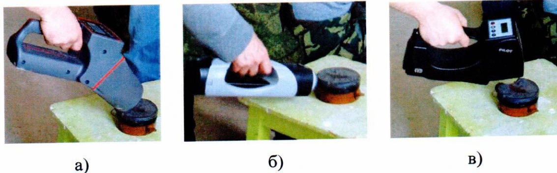
Рисунок 5 – Обнаружение противопехотной мины ПМН:
