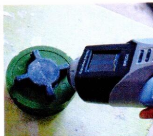
Рисунок 8 – Обнаружение противопехотной мины ПМН-2: а) – прибором «Заслон-М», б) прибором «Бирюч», в) прибором «Пилот-М1»
