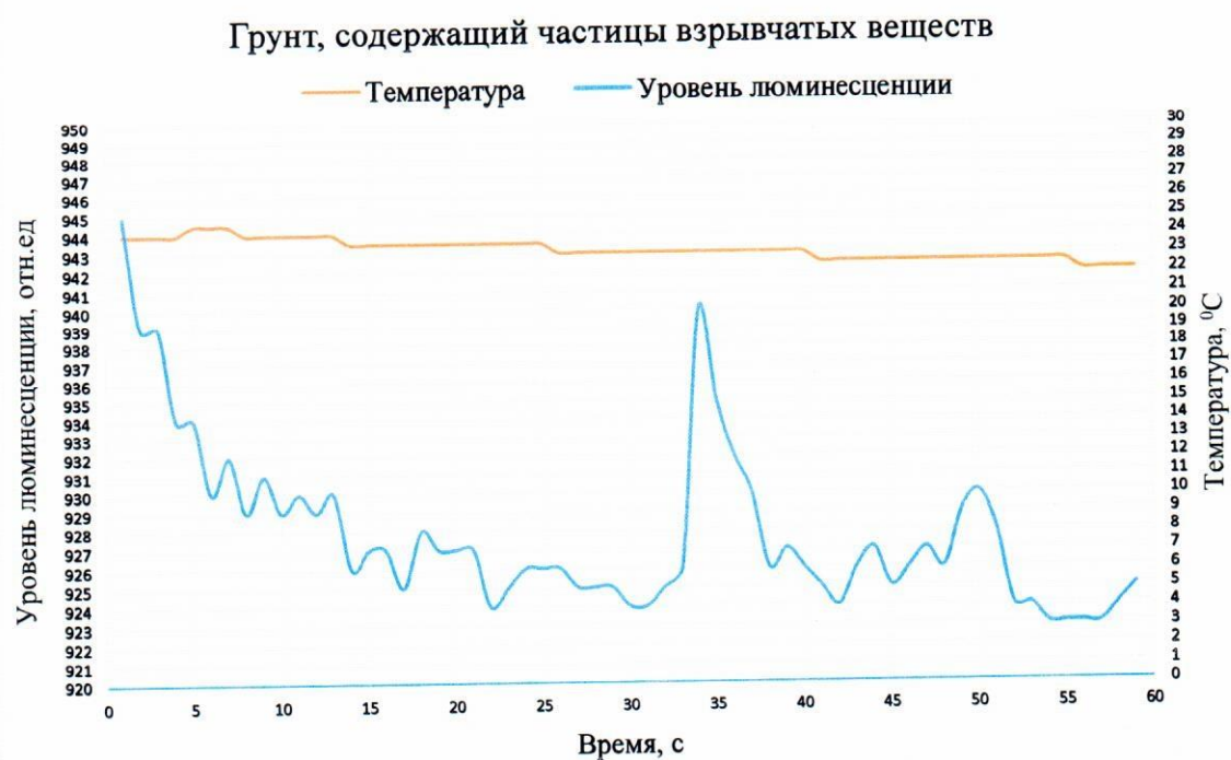
Рисунок 25 – Динамика показаний чувствительного сенсора при поднесении прибора «Заслон-М» к грунту, содержащему частицы ВВ
