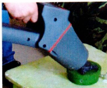
Рисунок 8 – Обнаружение противопехотной мины ПМН-2: а) – прибором «Заслон-М», б) прибором «Бирюч», в) прибором «Пилот-М1»
