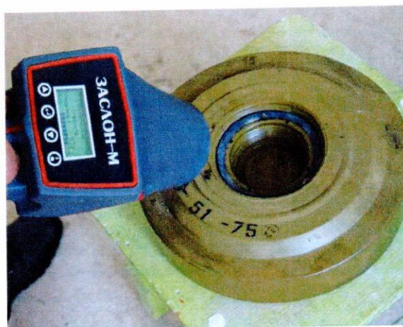
Рисунок 17 – Обнаружение противотанковой мины ТМ-62М прибором «Заслон-М»
