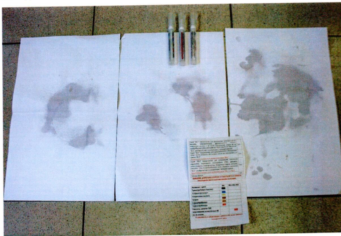
Рисунок 30 – Смывы химического состава экспресс теста ВВ с поверхностей объектов поиска
