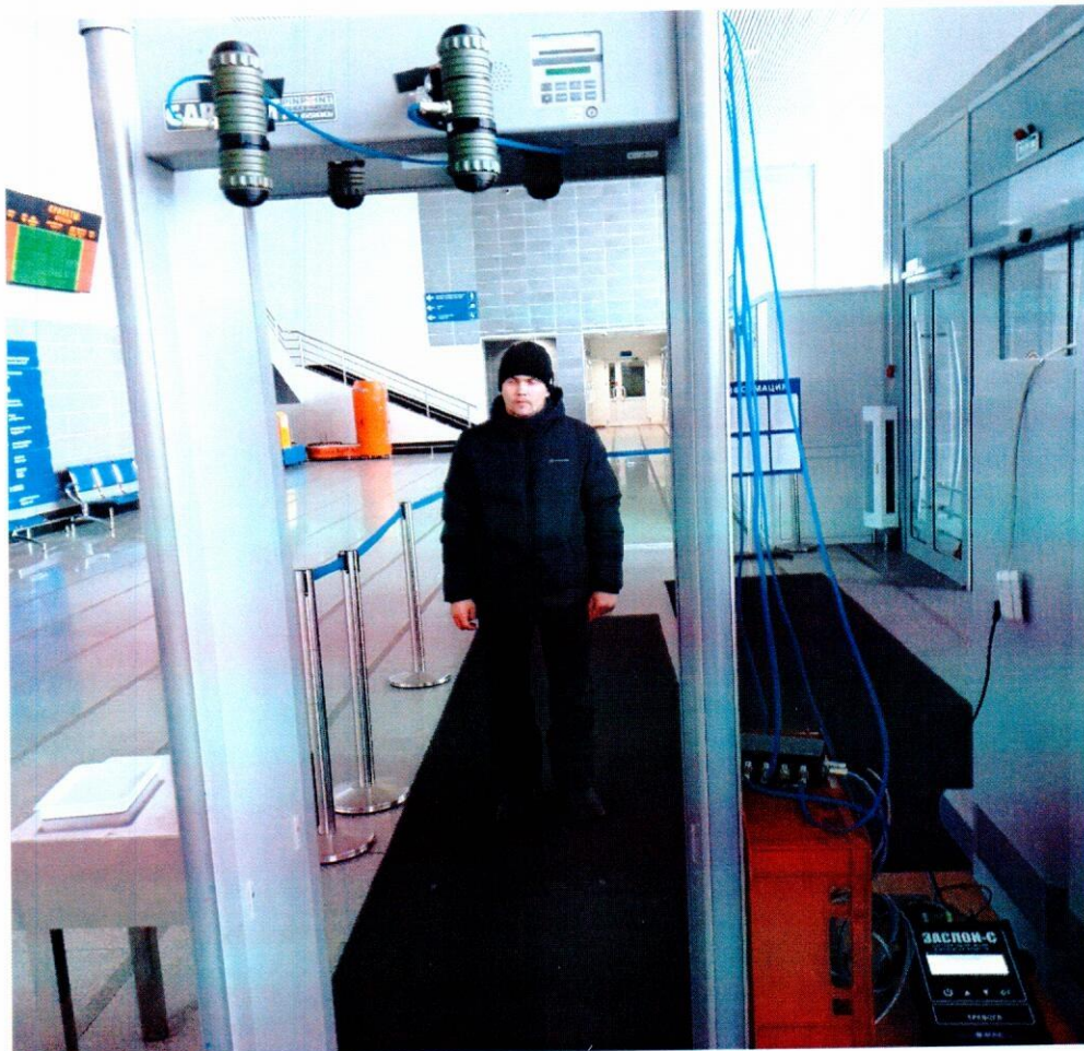
Рисунок 6 – Статист, моделирующий подход террориста смертника с «поясом шахида» к системе «Заслон-С»
