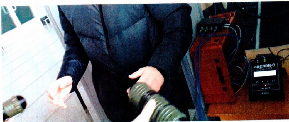
Рисунок 9 – Фиксация паров ВВ в области запястья человека с ВВ под одеждой
