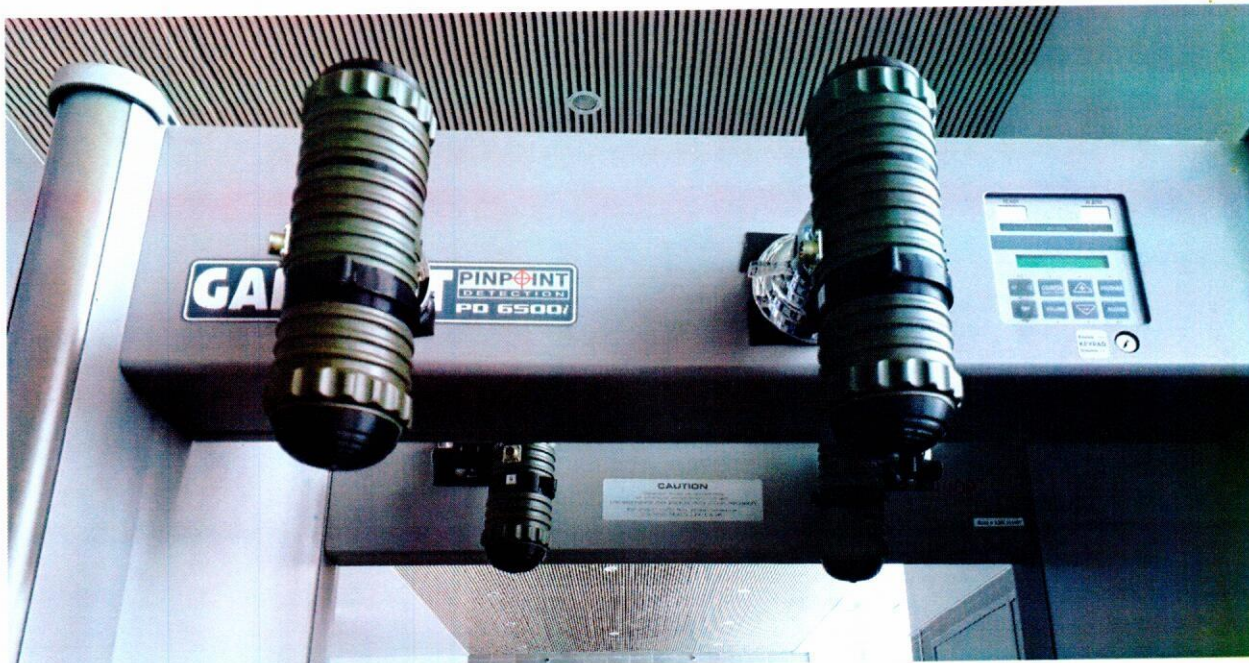
Рисунок 2 – Расположение воздухозаборных элементов системы на рамке металлодетектора
