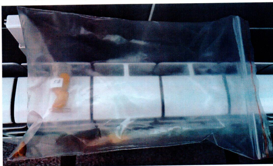
Рисунок 4– Накопление концентрации паров ВВ соответствующей концентрации паров вблизи реальных взрывных устройств
