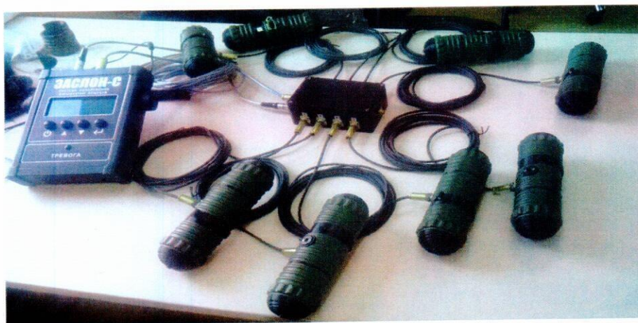
Рисунок 1 – Универсальная система по обнаружению паров ВВ «Заслон - С»
